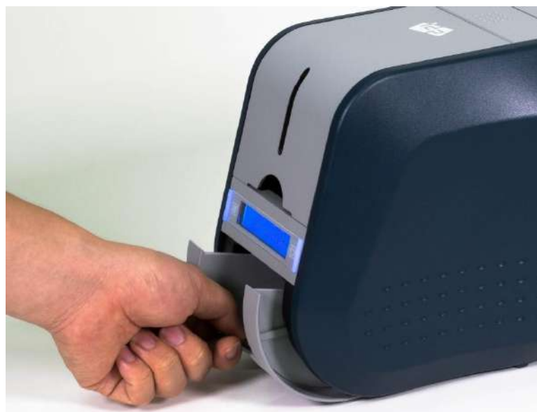
Рис. 32 SOLID-510 Изъятие лотка и разведение в стороны
