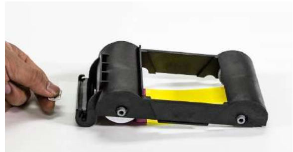
Рис. 18 Удаление защитной ленты
