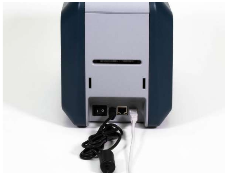
Рис. 9 SOLID-510S Коннект кабеля питания и USB кабеля
