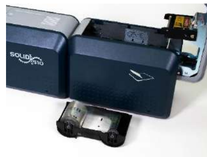
Рис. 22 Установка пленки ламинатора
