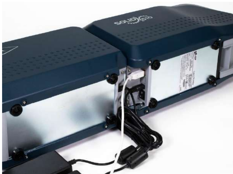
Рис. 11 SOLID-510L Коннект обоих кабелей питания и USB-провода
