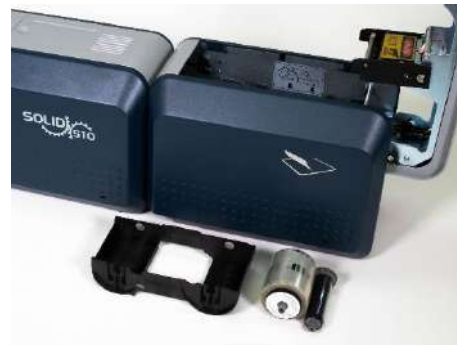
Рис. 21 Удалите картридж с ламинирующей лентой
