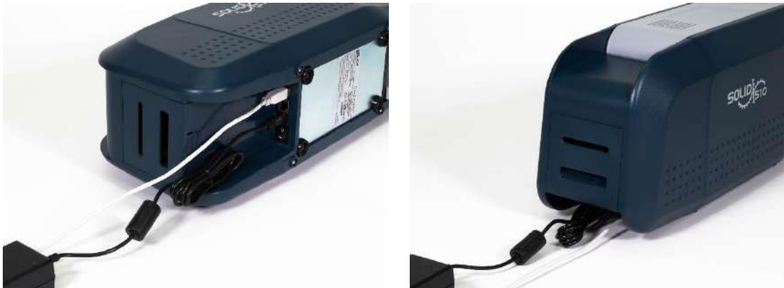
Рис. 10 SOLID-510D Коннект кабеля питания и USB кабеля
