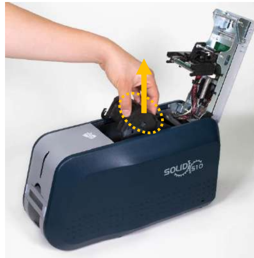
Рис. 14 Изъятие картриджа с печатной лентой
