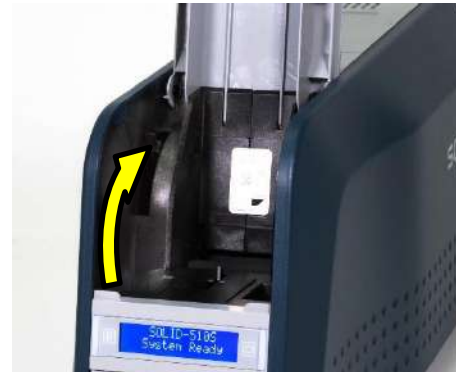
Рис. 24 Механизм настройки толщины карт
